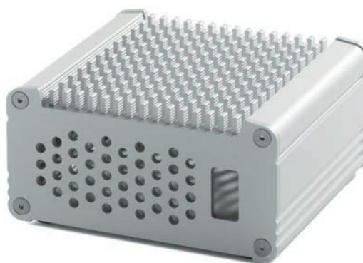
ヒートシンクに垂直方向の溝加工を入れる事で、ピン型フィン形状にする事が可能です。表面積がさらに大きくなり、放熱効果がアップします。
